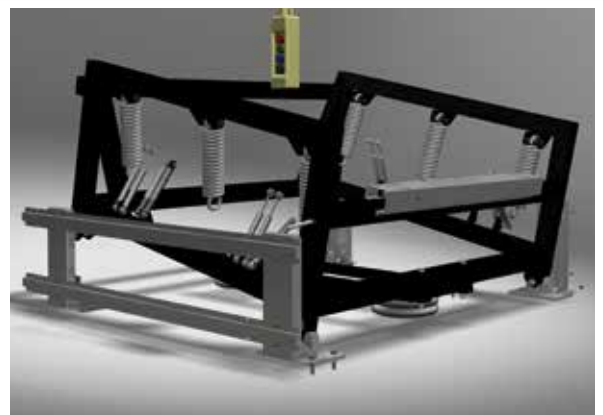
Systém předního a zadního překlacení pro usnadnění a urychlení naplnění a vyprázdnění u praček s velkou kapacitou (60 a 120 kg). / Front and back tilting system for an easy and quick loading / unloading in big capacity machines (60 and 120kg).
